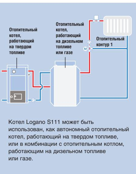
Котел Logano S111 может быть использован, как автономный отопительный котел, работающий на твердом топливе, или в комбинации с отопительным котлом, работающим на дизельном топливе или газе.
