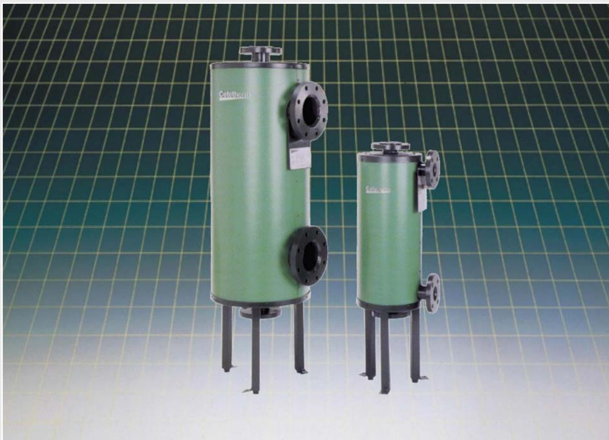
**Cetecoil®** - теплообменник, теплопередающая поверхность которого выполнена из трубок кислотостойкой стали. Благодаря этому он применим для многих типов теплоносителей, таких как пар, горячая вода, горячее масло. В системах с паром Сетекойл может использоваться в качестве высокоэффективного конденсатора. Теплообменник хорошо подходит для систем с непрерывным режимом эксплуатации и большими скоростями потока теплоносителя.
